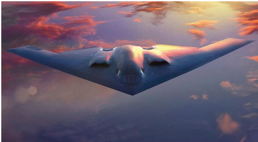
■升力体设计从原理上来说很简单,就是机身纵向剖面设计成上鼓下平的机翼形状。
