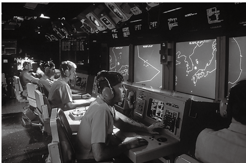
■“宙斯盾”巡洋舰上的4部42寸大屏幕显示器，“基德”舰上只有2部，因而防空管制能力不如前者。
