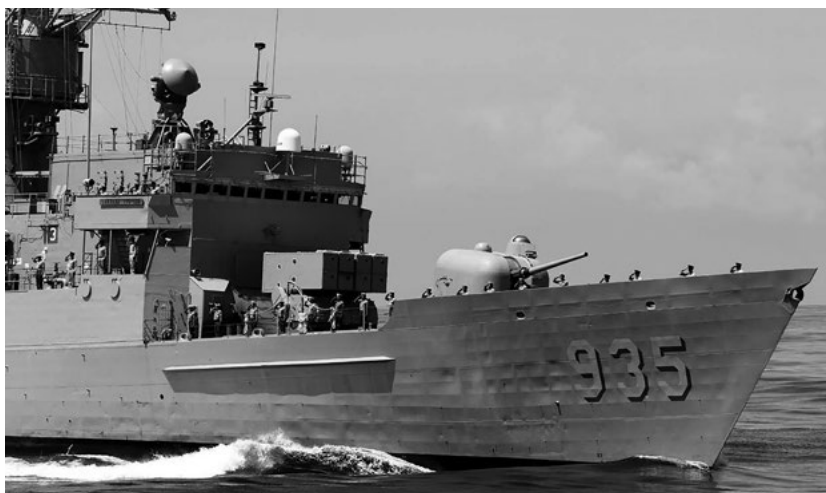
■FFG-935“兰阳”号护卫舰,可见其舰桥顶部的一具STIR-180。
