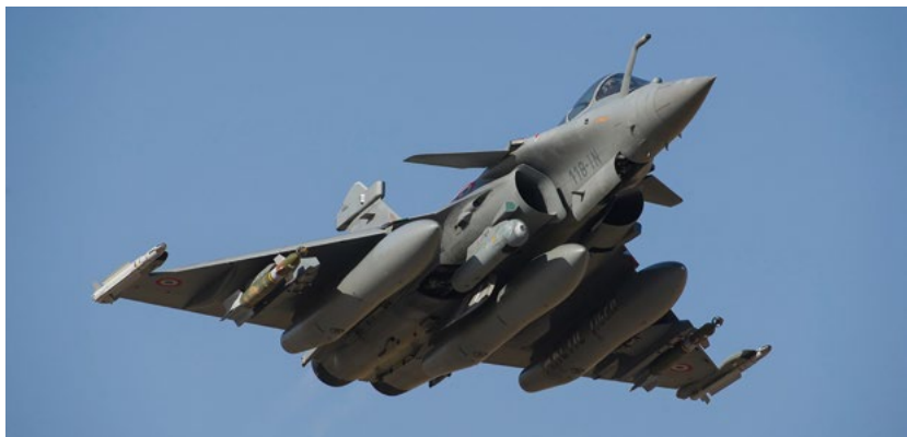
■通过采用鸭翼设计,法国“阵风”战斗机的性能要超过现在很多的三代机。
