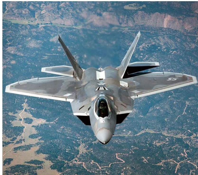
■美国F-22战斗机在发动机和航电设备上的巨大优势上采用了较为常规的气动布局,飞机设计过于紧凑导致限制了潜力发挥。
