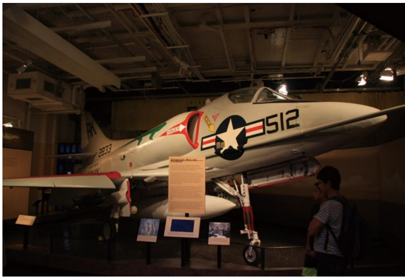
■A-4“天鹰”舰载攻击机是纯粹的舰载机，在最初就以拦阻着舰的结构强度标准来设计。
