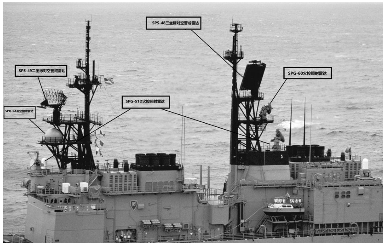
■经过NTU升级的“基德”级驱逐舰雷达系统概貌,在原先安放SPG-60的位置增添了一部SPS-49,原SPG-60则被移到后桅杆,另外SPS-48E的位置也有少许改动
