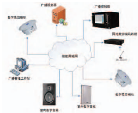
图 1 IP 数字广播系统结构图
