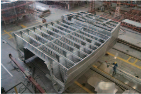
图 1 采用 5000 系铝合金材料建造的双体船分段
