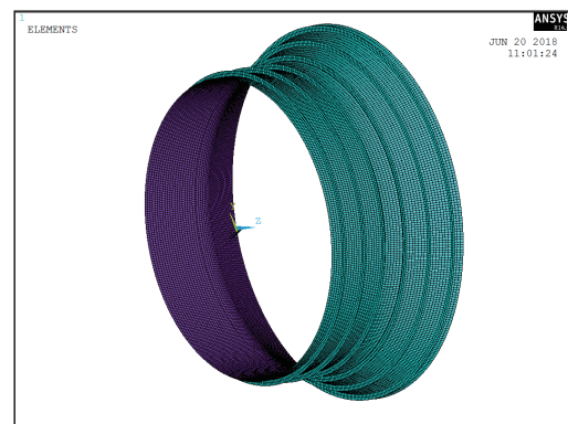
图 2 加肋凹型锥-环-柱结合壳有限元模型示意图
